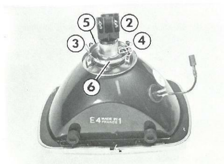
Fig. 34 - Projecteurs 2 - Connecteurs 3-4 - Ressorts de maintien 5 - Collerette d'ampoule 6 - Ergot de positionnement
